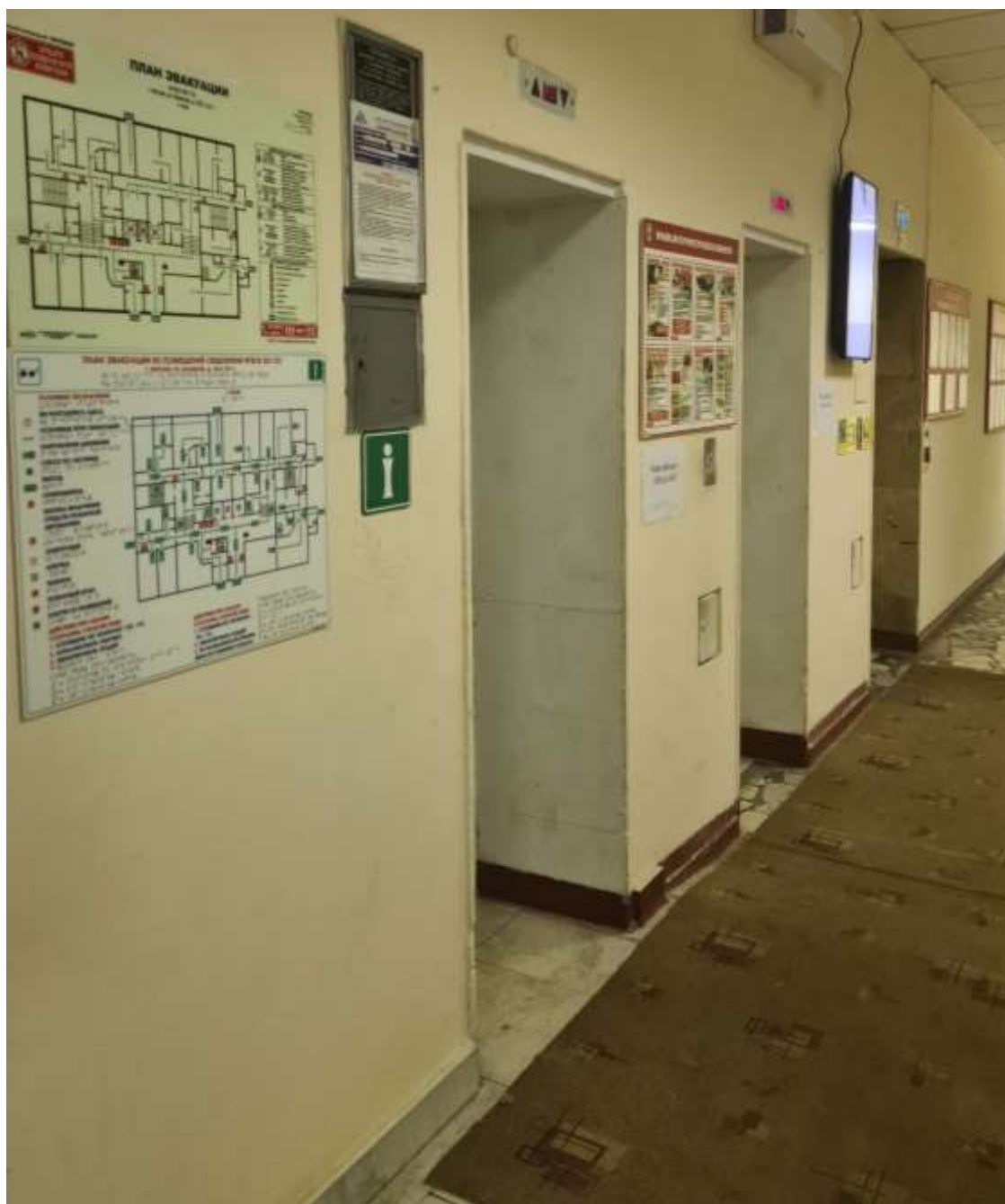
Фото коридора на 1 этаже с лифтами и тактильной эвакуационной схемой, дублированной шрифтом Брайля.
