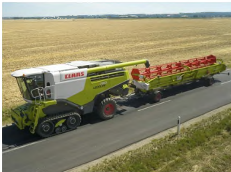
Рисунок 17 - Переезд зерноуборочного комбайна Claas Lexion S 780 на полугусеничном ходу с транспортной тележкой с поля на поле [81]
