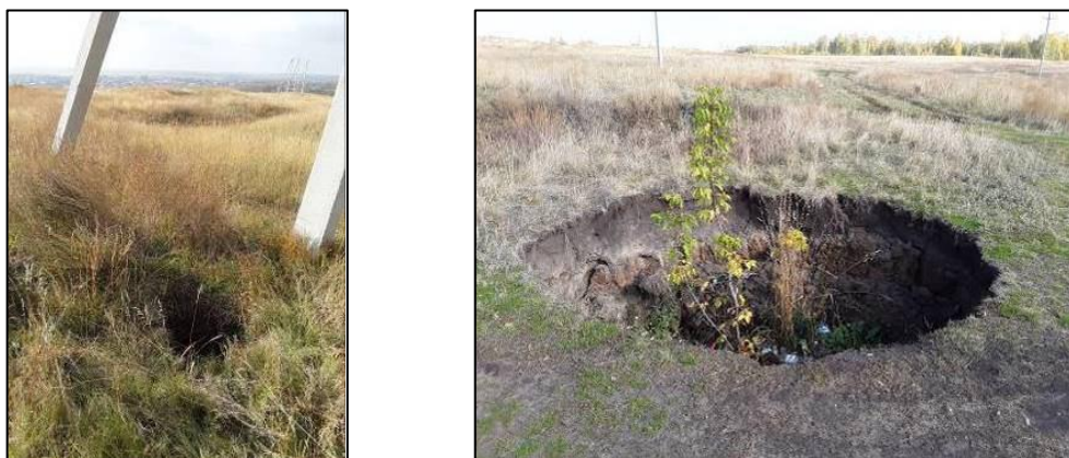
Рисунок 19 – Провалы на карстово-суффозионном участке «Лысая Гора»
