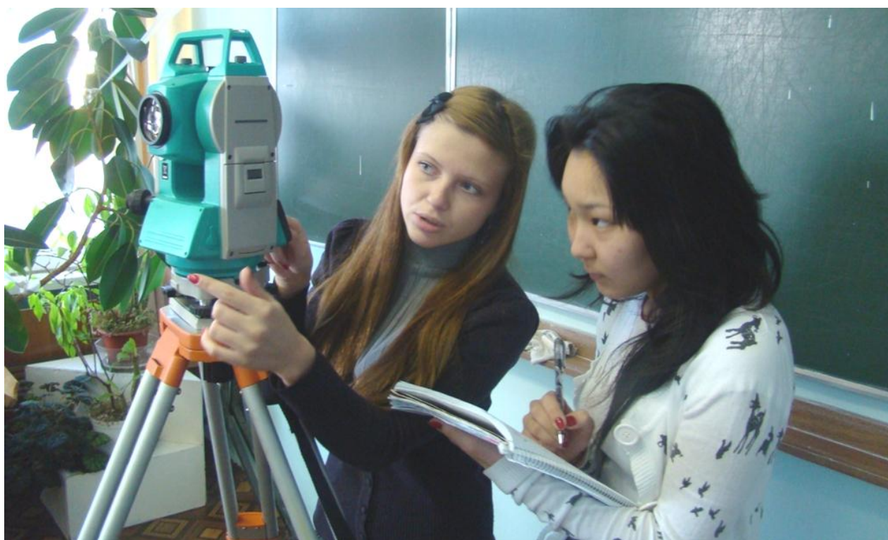
Фото 10. На лабораторных занятиях по геодезии. Работа с электронным тахеометром SET 610. Студенты первого курса специальности «инженер городского кадастра» ИЗКиП КрасГАУ Обухова Ирина и Монгуш Дамырак
