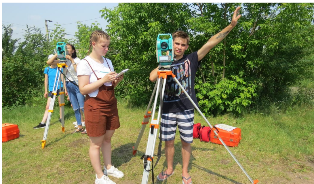
Фото 6. Учебная практика. Тахеометрическая съемка электронным тахеометром SET610
