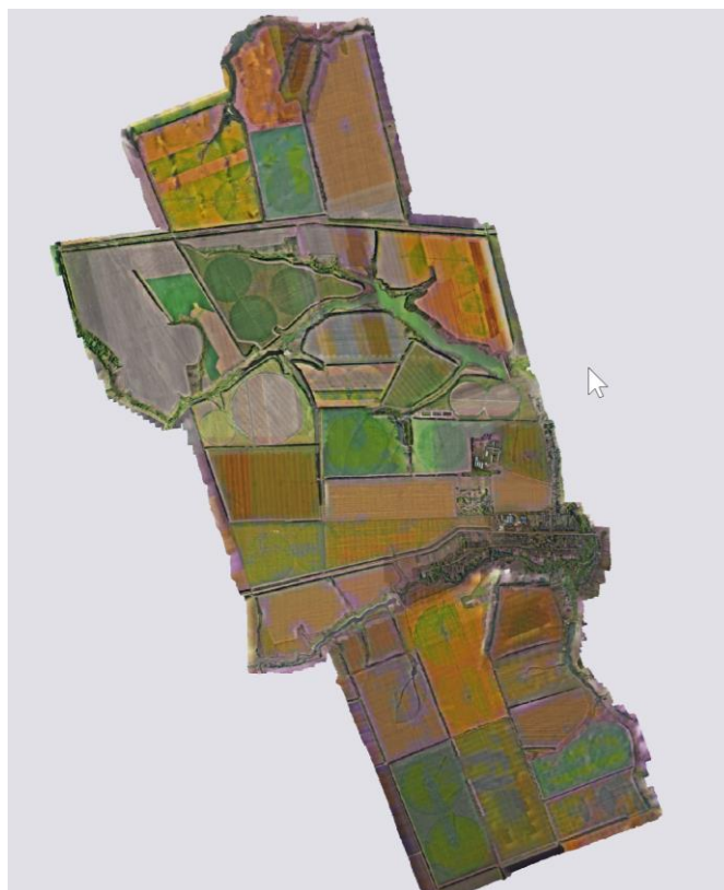
Рисунок 3.23 – Ортофотоплан, полученный с помощью БПЛА
