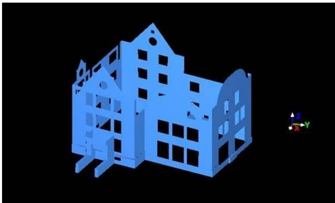
Рис. 5. Трехмерная модель, построенная по облаку точек.
